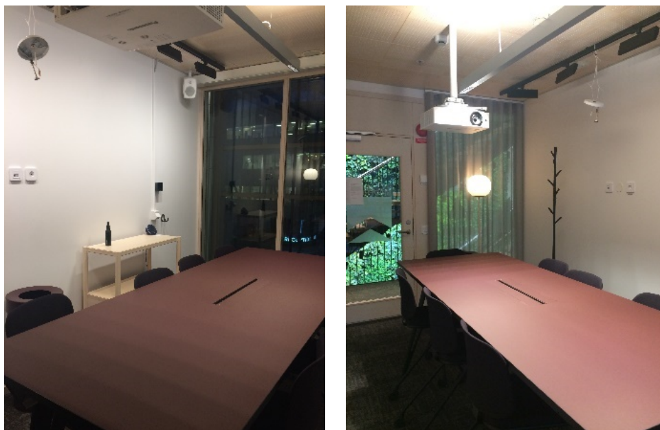
Figur 1 Inuti testkontoren: kontor 3104 till vänster och 4104 till höger. Aldehyd- och TVOC-provtagare fästs på skivorna som hänger från spotlight-skenorna under taket.
